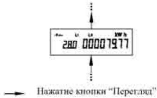
Рисунок Ж.1 – Выводимые окна счетчиков НIK 2303 АТ2
