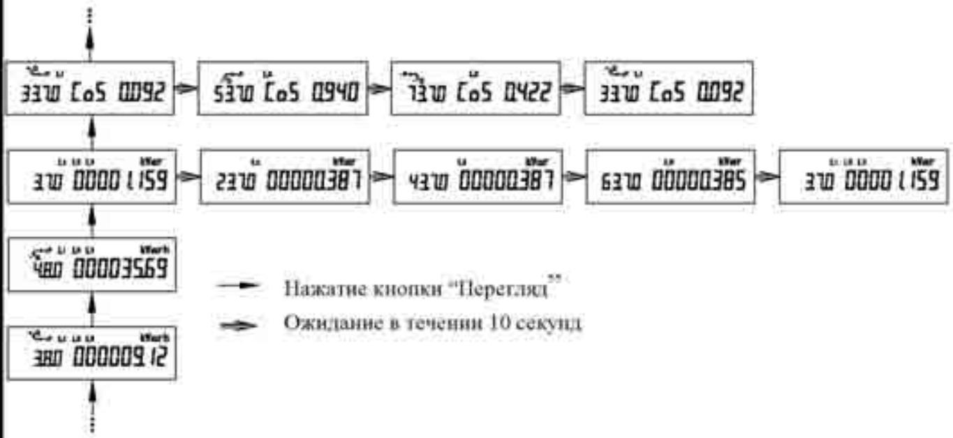
Рисунок Г.1 – Выводимые окна счетчиков НСК 2303 АРП1 (АРП2, АРП3, АРК1)
